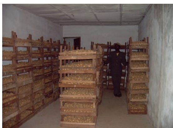
PHOTO 1 : MODELE DE CAISSE EN BOIS POUR LE STOCKAGE DE LA POMME DE TERRE (60 X40 X 40 CM)
